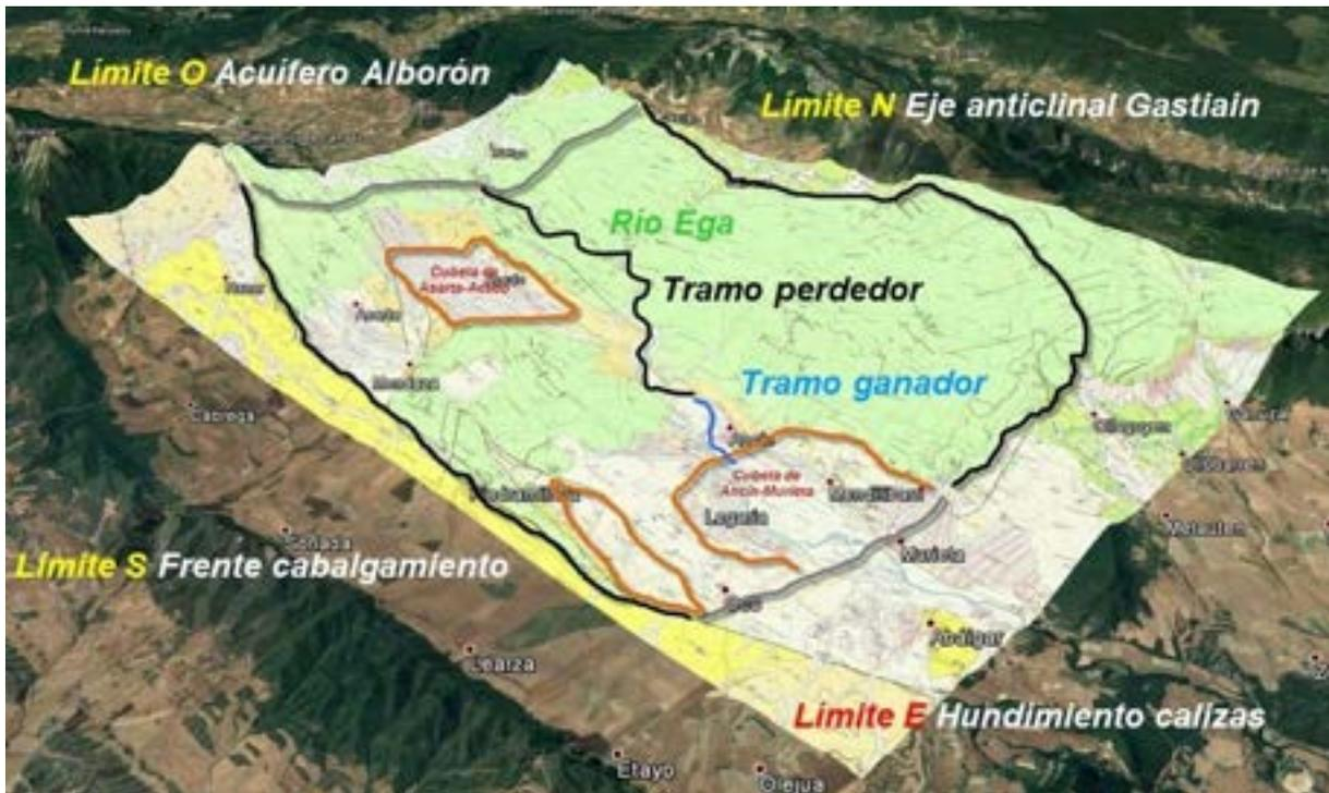
FIGURA 9. ESQUEMA CONCEPTUAL DEL SUBSECTOR DE ANCÍN DEL ACUÍFERO SIERRA DE LÓQUIZ. FUENTE DE DATOS: ESTUDIO “REALIZACIÓN DE UN ENSAYO DE BOMBEO DE LARGA DURACIÓN Y ELABORACIÓN DE UN MODELO HIDROGEOLÓGICO COMO SOPORTE PARA LA EXPLOTACIÓN RACIONAL DEL ACUÍFERO EN EL SECTOR DE ANCÍN”. GOBIERNO DE NAVARRA (DICIEMBRE DE 2017).
